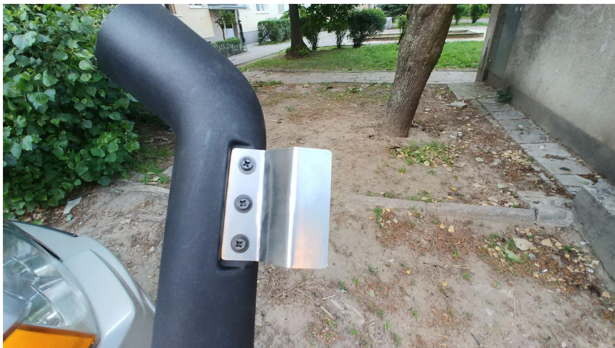
Snorkel razem z blachą do przymocowania do słupka (oryginalna blacha dołączona do zestawu się do tego nie nadaje).
